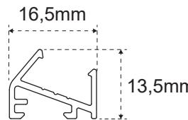
KIT DI FISSAGGIO / FIXING KIT / BEFESTIGUNGSKIT /
